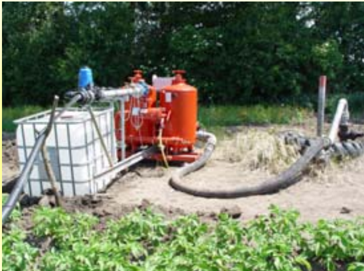
Kopfstation – Tropfbewässerungsversuch Herbsleben 2006
