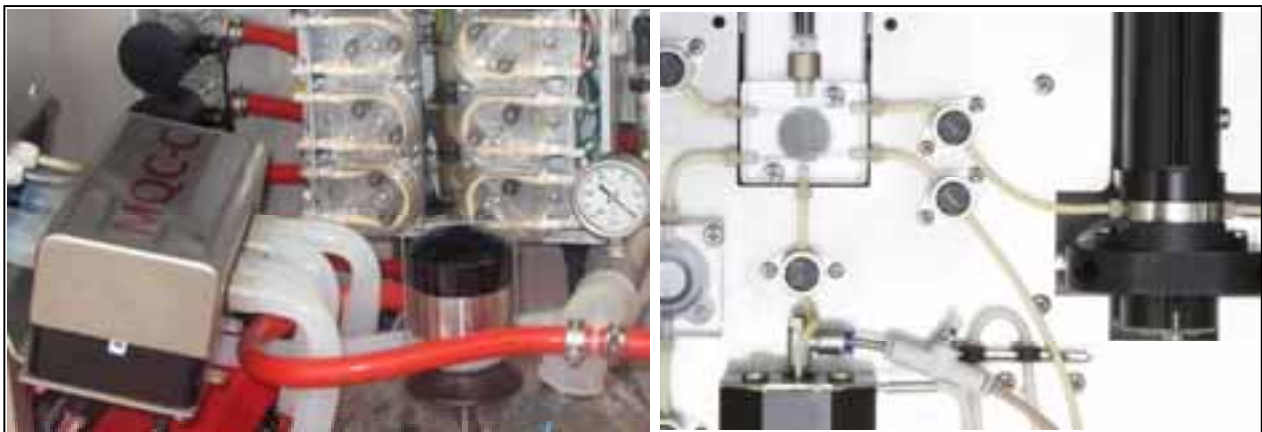
Abbildung 2: Systeme zur Bestimmung des Zellgehalts in der Milch (Quellen: LELY, DELAVAL)
