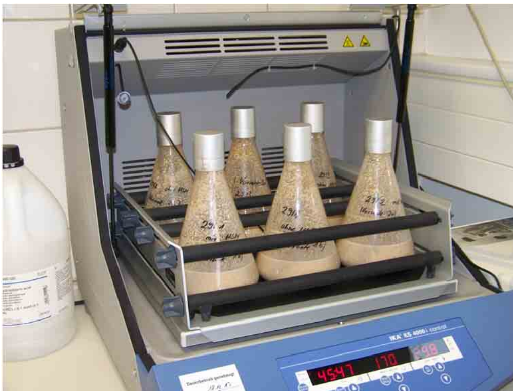
Abbildung 9: Ansicht eines zur Fermentation eingesetzten Inkubationsschüttlers
