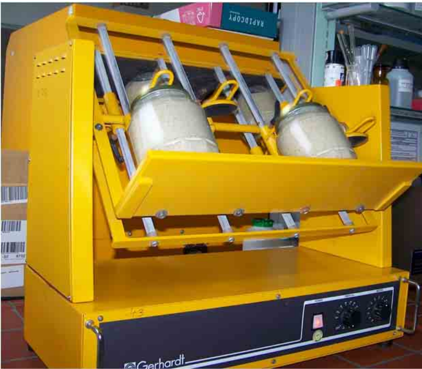
Abbildung 4: Einsatz Rotationsschüttler für Fermentationsversuch
