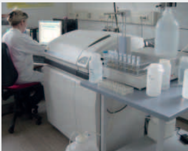
Anorganische Ultraspurenanalyse in Ernteproduktproben mit ICP-DRC-MS
