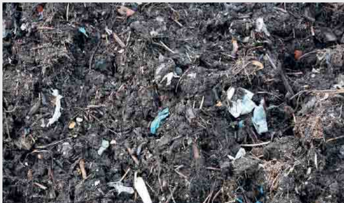
Beanstandeter Klärschlammkompost mit Fremdbestandteilen
