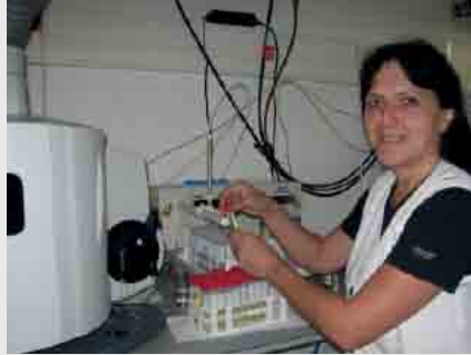
Homogenitätstest der Ringversuchsproben mit Atomemissionsspektroskopie mit induktiv gekoppeltem Plasma (ICP-AES)
