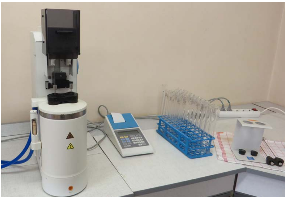
Abbildung 2: Fallzahlgerät Falling Number 1900 der Firma Perten Instruments mit Viskometerröhrchen und Viskometer (Foto: Herzog, 2016)
